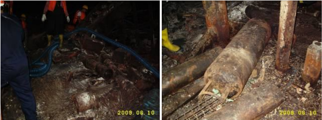
Gambar II-1 Kondisi Muatan Truk BM 8998 AK (asal api) dan Botol gas yang berada di dekat truk
