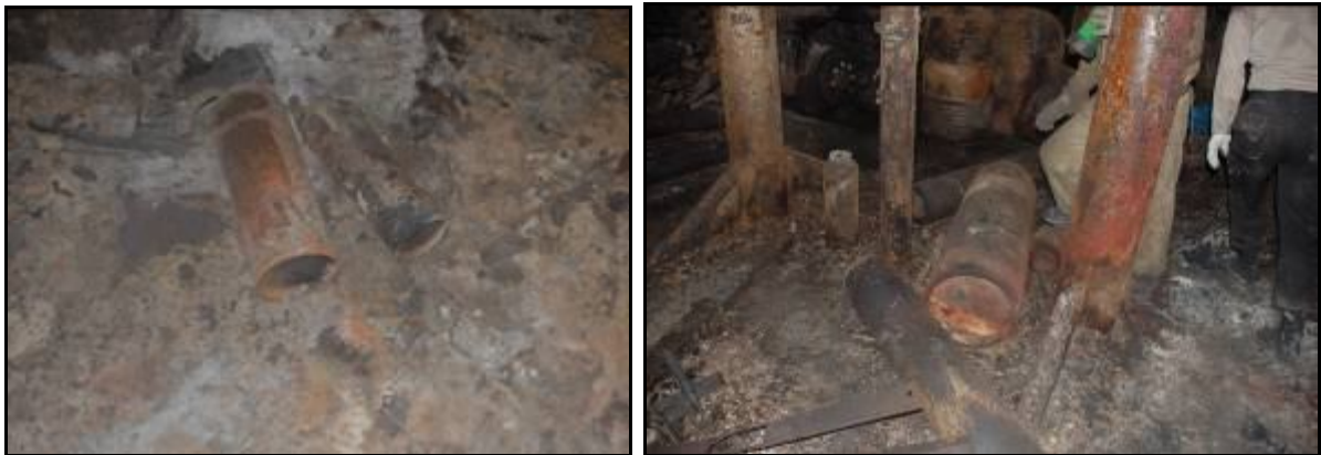
Gambar II-4 Bekas alat pemadam api ringan yang ditemukan di lokasi titik awal kebakaran
