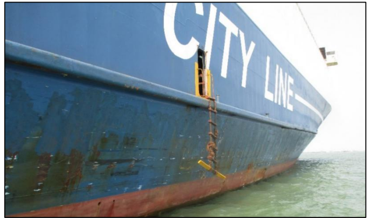
Gambar 7: Tangga pandu tidak dapat menempel karena bentuk lambung kapal yang tidak tegak lurus
