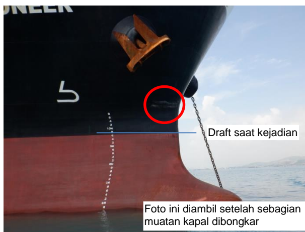
Gambar I-3: Bekas Tubrukan dengan Barokah Jaya di Haluan Habco Pioneer (Lingkaran Merah)
