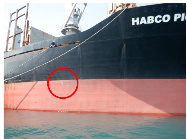
Gambar I-4: Bekas Tubrukan dengan Barokah Jaya di Haluan Kanan Habco Pioneer
