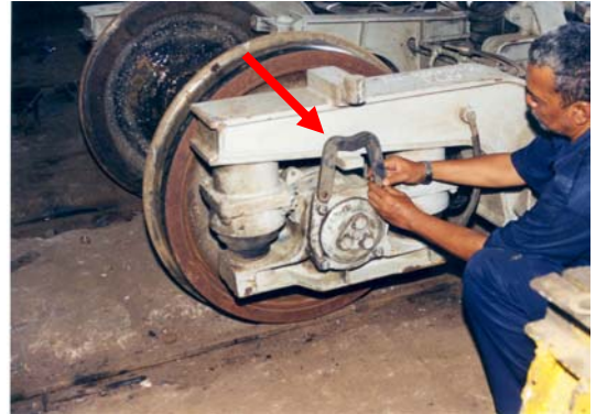
Gambar 14. Proses pelepasan M bracket
