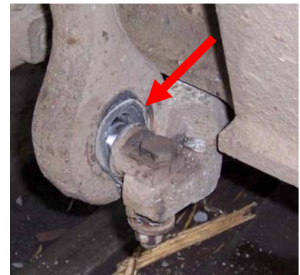
Gambar 12. Lubang Baut anti roll bar mengalami rekondisi
