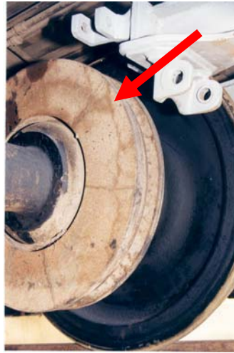
Gambar 11. Disc brake retak
