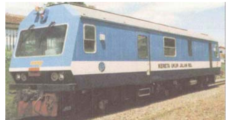
Gambar 6. Gerbong Kereta Ukur (dokumentasi PT. KA)
